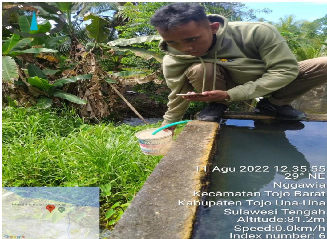
Foto 3. Pengukuran debit sumber air
